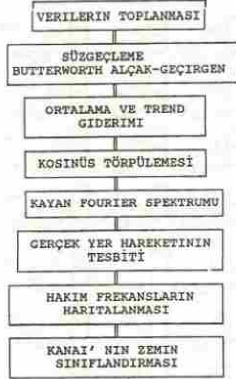
Şekil 5: Veri analizi akış diyagramı Figure 5: Flow chart of the data processing
