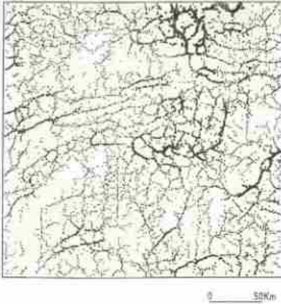
Şekil 8: Havadan manyetik anomalilerin yalancıgravite anomalilerinin en büyük yerleri. Çemberlerin büyüklükleri gradyanın büyüklüğü ile orantılıdır.
