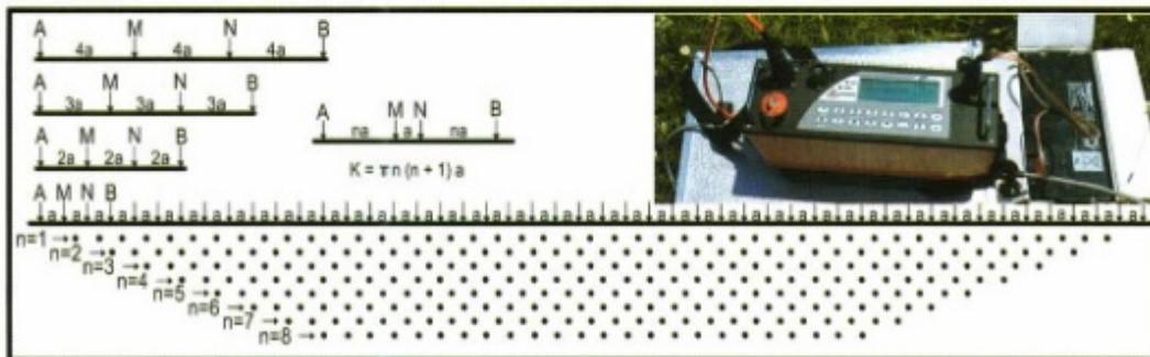
Şekil 2. 48 Elektrotlu Wenner-Schlumberger Elektrot Dizilimi ve Kullanılan Aygıtın Görünümü.
