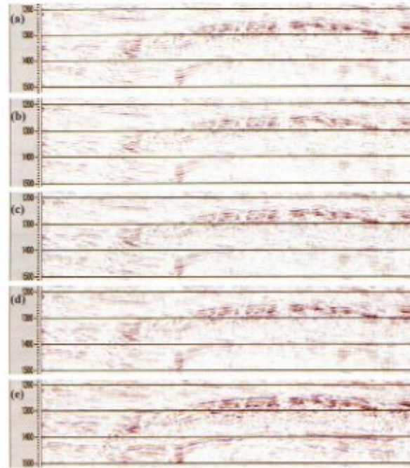
Şekil 15. (a) Dekonvolüsyonsuz, (b) \alpha=7ms ve n=43ms , (c) \alpha=10ms ve n=40ms , (d) \alpha=12ms , n=38ms , (e) ofset bağımlı önkestirim dekonvolüsyonu sonucu elde edilen yığma kesitleri (1220-1500ms).
